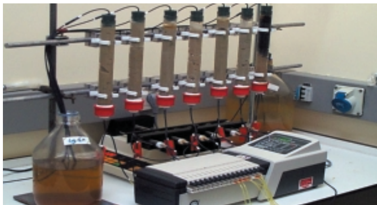
Proefopstelling van in-situbioprecipitatie, een goedkope en duurzame techniek om zware metalen en sulfaten uit grondwater te verwijderen.
