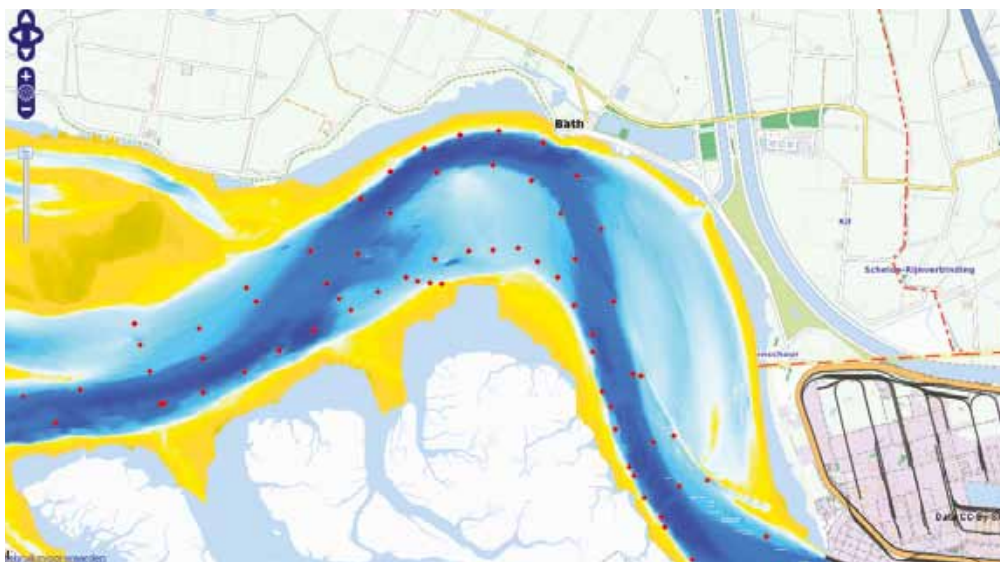
De geel-blauwe zone visualiseert de diepte van de Schelde nabij de bocht van Bath. De donkerblauwe zone is de vaargeul die regelmatig gebaggerd wordt en waarvan de dieptegegevens bevroegbaar zijn via onze nieuwe webtool. De vaargeul wordt afgebakend met boeien die zichtbaar zijn als rode punten.
