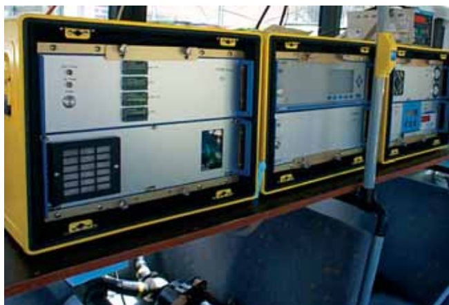
Het VOEMLaag-systeem van Vito meet de concentratie van vervuilende componenten in de uitlaatgassen van de lijnbus. VOEMLaag werd specifiek ontworpen voor het opmeten van lage concentraties onder reële verkeersomstandigheden.
