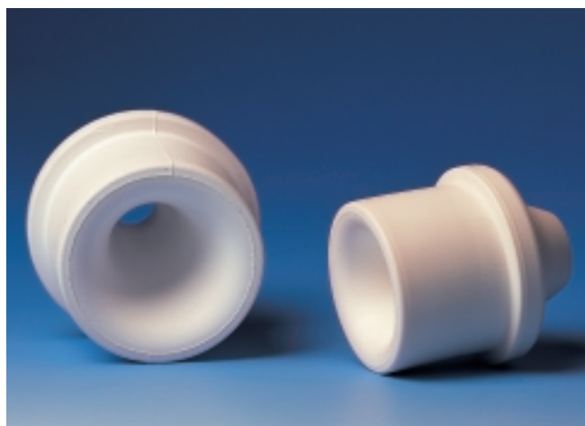
Keramische spuitkop gemaakt door gelgieten, met inuline als biogelvormer.
