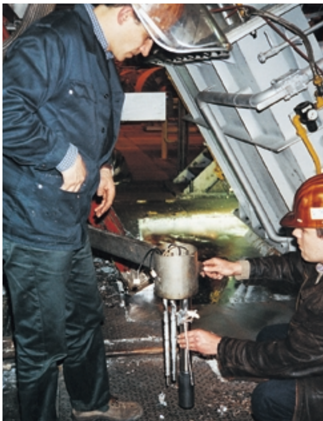
De Alzin-sensor wordt aan het zinkbad, samen met een thermokoppel, op een beweeglijke arm gemonteerd.
